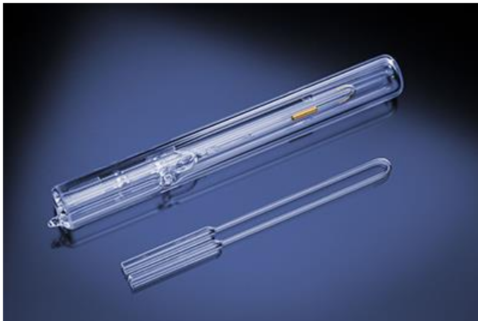
Рисунок 4. Попереду U-трубка окремо та коливальний датчик густини з U-трубкою позаду. U-трубка наповнена досліджуваним зразком і коливається з власною частотою. Густину зразка отримують з цього значення.
